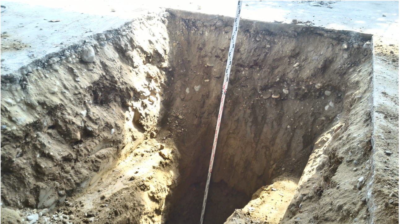
Illustrazione 21 sviluppo della trincea di Pz3 in questo caso emerge che l'unità del primo metro è costituita da materiali di riporto in cui la parte terrosa, costituita da ghiaie e ciottoli è prevalente, in quanto doveva fornire supporto alla pavimentazione.
